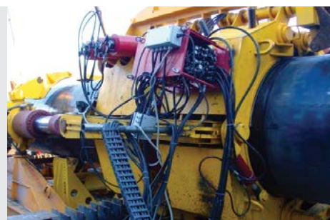
Установка УПТ-700 проталкивания труб в туннельном переходе для транспортировки нефтепродуктов, Краснодарский край.
