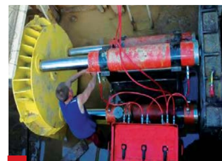
Установка для бестраншейной прокладки труб серии УБПТ «Горизонт» на особо важном государственном правительственном объекте «Трубопроводная система «Восточная Сибирь – Тихий Океан».
